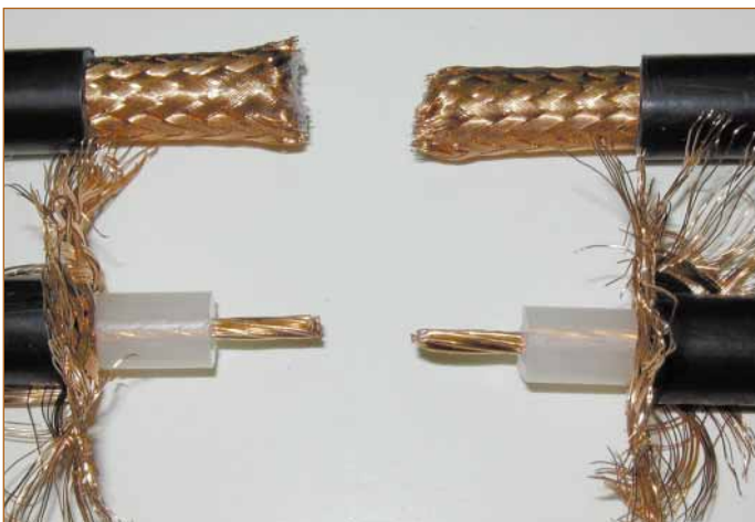
FIGURA NÚMERO TRES: AISLANTE CENTRAL RETIRADO.
