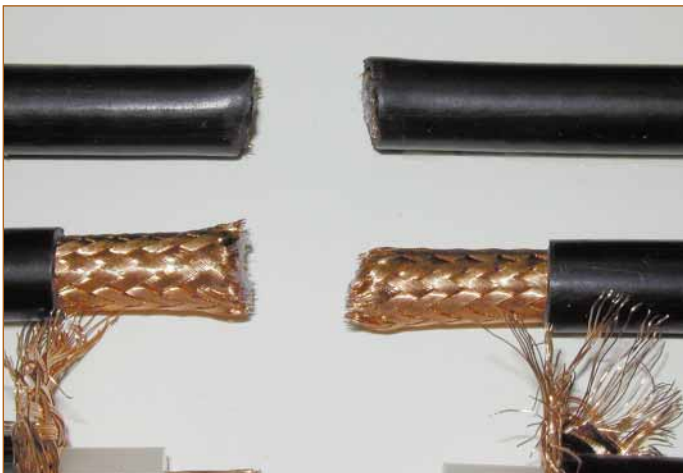
FIGURA NÚMERO DOS: CUBIERTA RETIRADA.
