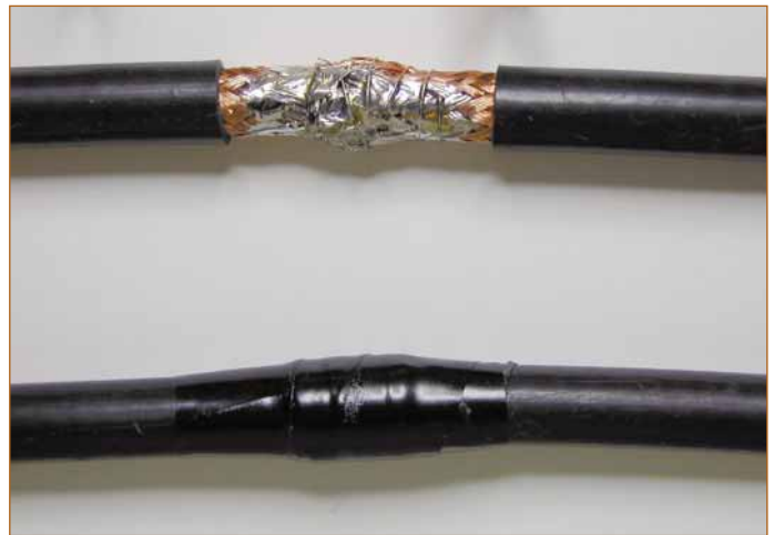
FIGURA NÚMERO SEIS: SOLDADO DE MALLAS. ENCINTADO.
